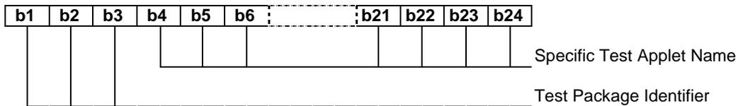
Test package Identifier( bits b1-b3):
