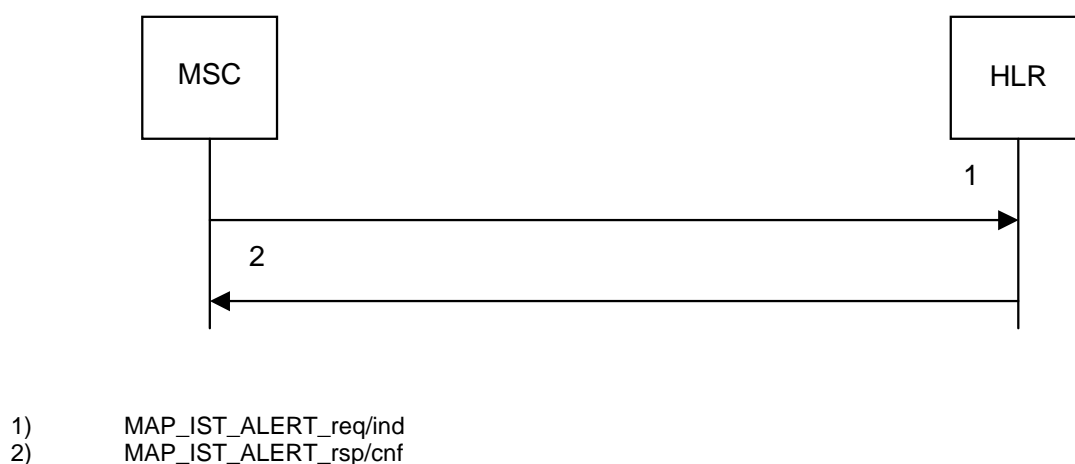
Figure 21.9/1: Message flow for IST Alert
