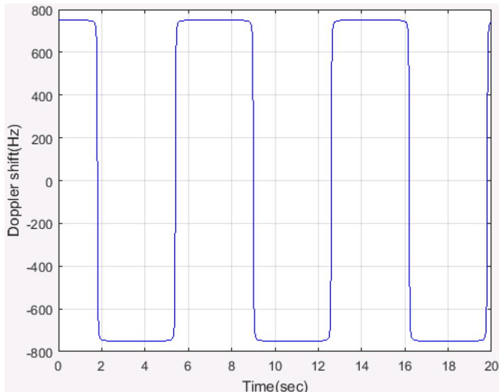
**Figure B.3.1-1: Doppler shift trajectory ( $f_d = 750$  Hz)**
