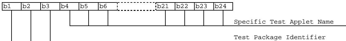
Test package Identifier( bits b1-b3):
