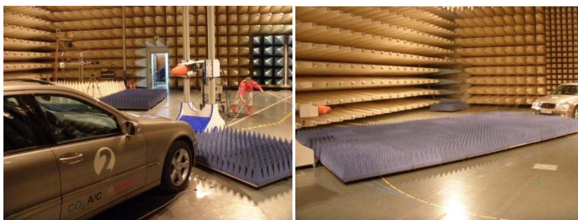
(d) RX antenna at 3 m and 1,45 m height (8,5°)
