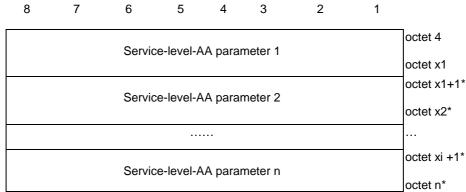
Figure 9.11.2.10.2: Service-level-AA container contents
