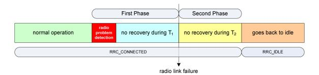
Figure 10.1.6-1: Radio Link Failure
